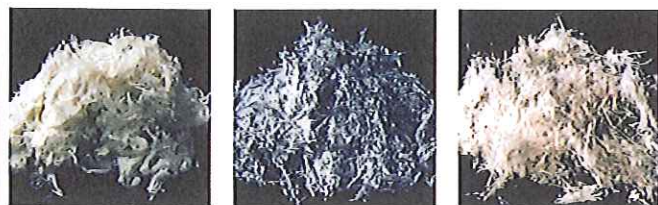
白石綿 (クリンタイル)
