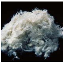
白石綿 (クリンタイル)
