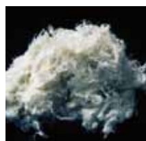
白石綿 (クリソタイル)
