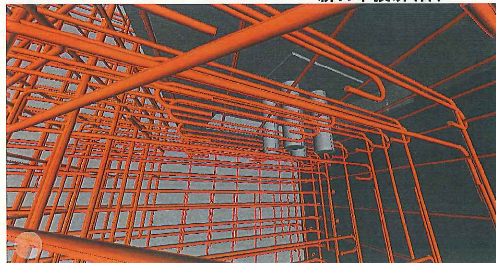
配筋モデル(支沓アンカー箱抜き)
