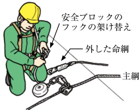
注意：ここでいう架け替えとは、はしごに設置された安全ブロックのフック（これまで利用してきたもの）から、新たに屋根棟に設置した安全ブロックのフックへの架け替えのことである。
