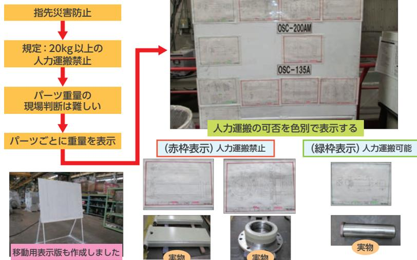
重量20kg以上のものの人力運搬は禁止としているが、機械部品の重量を現場で判断するのは難しい。そこで、図面を色分けして現場に表示し、人力運搬可否の「見える化」を図った。
