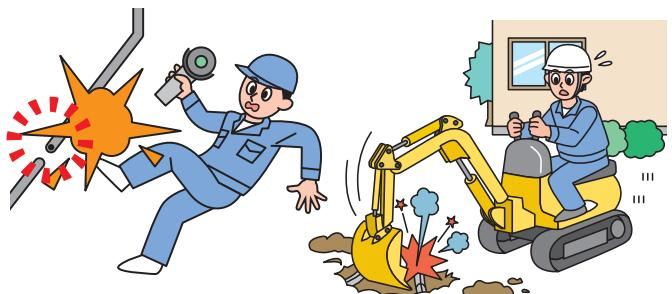
ガス管の位置を確認せずに工事を行なうとガス管を損傷し、ガス漏れやガス爆発事故に至る場合があります。
