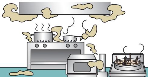
燃焼器を増やしたり、入れ替えた際に、給排気設備の能力が不足すると、給排気不全によりCOを含んだ排気が室内に滞留し、CO中毒の原因になります。
